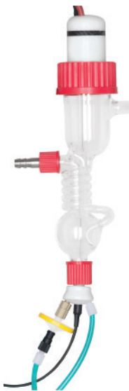
Steam-Jet Aerosol Collector (SJAC) of the 2060 MARGA.
