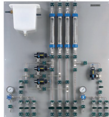
Pneumatische Probennahmesysteme für mehrere Probenströme
