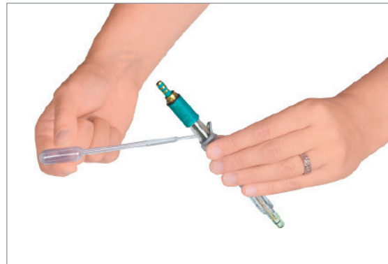
4. Anschliessend Elektrolytkammer entleeren
