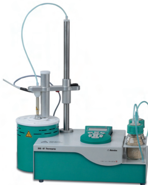
卡氏样品加热处理器原理图
