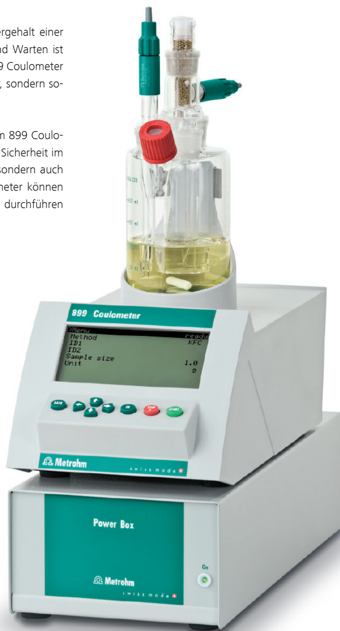
899 Coulometer mit optionaler Power Box für den Batteriebetrieb
