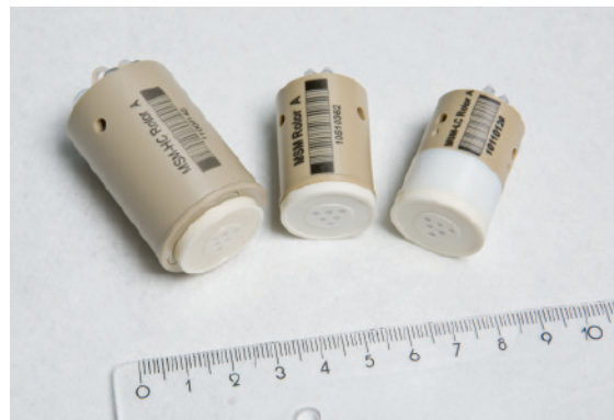
Les trois rotors de supprimeurs MSM-HC, MSM et MSM-LC sont de structure identique et se distinguent uniquement par leur capacité.
