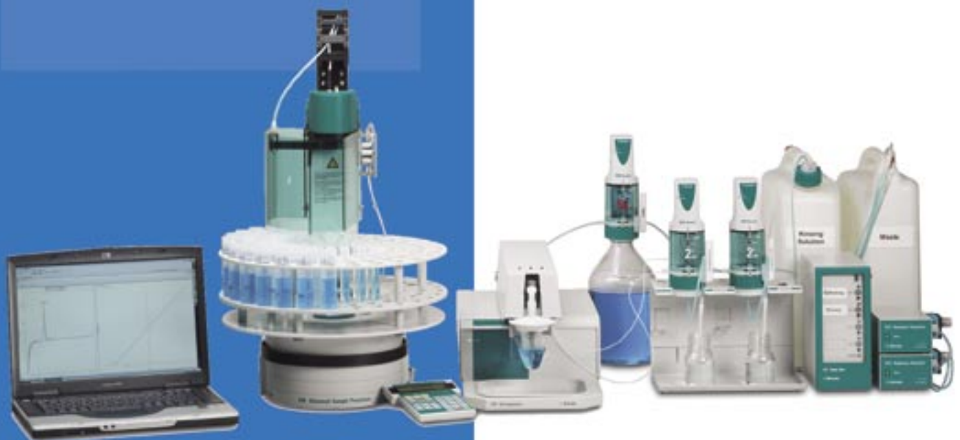
Vollständig automatisiertes Analysensystem für die Bestimmung von Glanzbildnern, bestehend aus VA Computrace 797, Advanced VA Sample Processor 838, drei Dosinos 800 sowie der Spülausrüstung.
