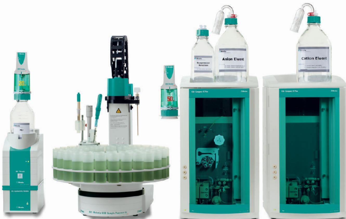
TitriC Vario pro II: sistema compuesto de un 856 Conductivity Module, dos 800 Dosino, un 802 Stirrer, un 905 Titrande, un 815 Robotic USB Sample Processor XL y dos 930 Compact IC Flex.
