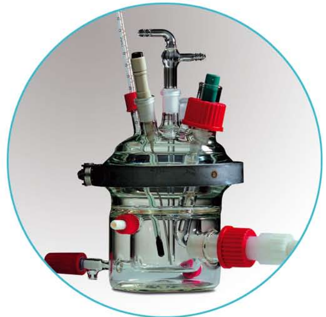
Thermostatierbare Korrosions-Messzelle – Probendurchmesser 14 mm – aktive Oberfläche: 0,785 cm 2
