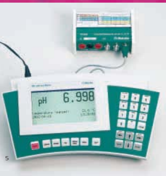
Contrôle de l'affichage pH du pH-/ionomètre 781 avec la Référence calibrée 767.
