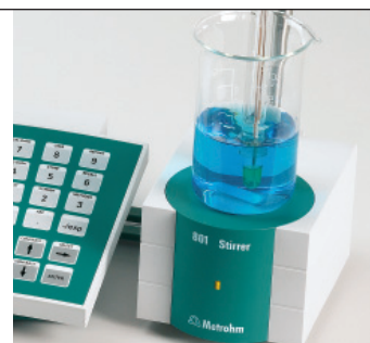
801 Magnetrührer am 781 pH-/Ionenmeter.
