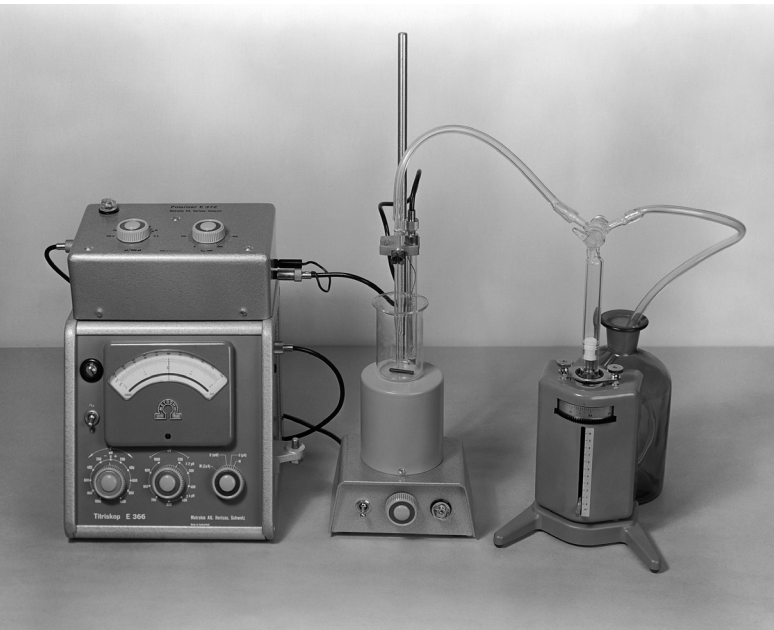
The Titriskop, the first Metrohm titrator (1949)
