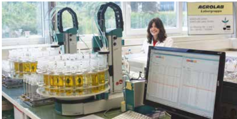
Vollautomatische Bestimmung des CSB-Wertes bei Agrolab Bruckberg mit zwei 855 CSB Robotic Titrosamplern
