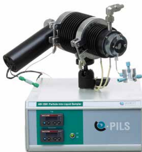
Der Particle Into Liquid Sampler. Die Kopplung zwischen IC und VA erlaubt, Ionen in Aerosolen zu bestimmen.
