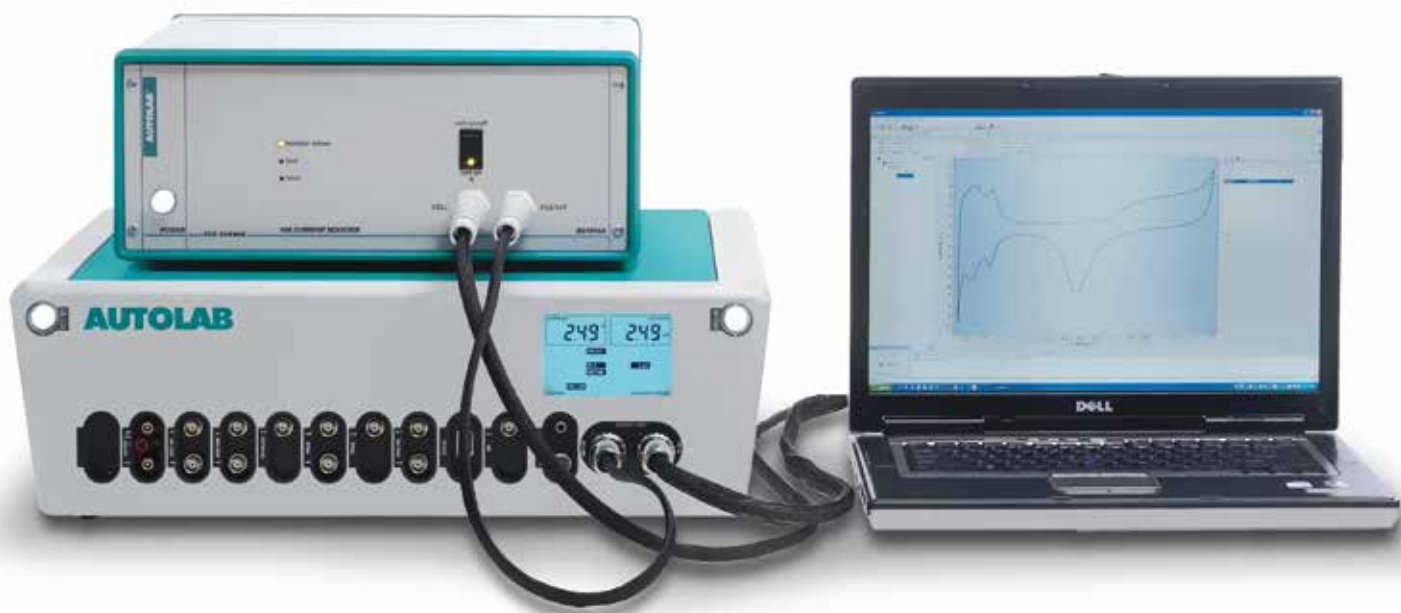
Autolab PGSTAT128N mit BSTR10A 10A Current Booster
