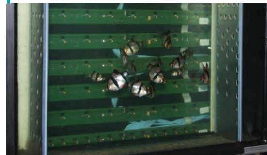
O ToxProtect64 monitora a atividade de nado do peixe em um aquário provido de água potável ou água da rede
