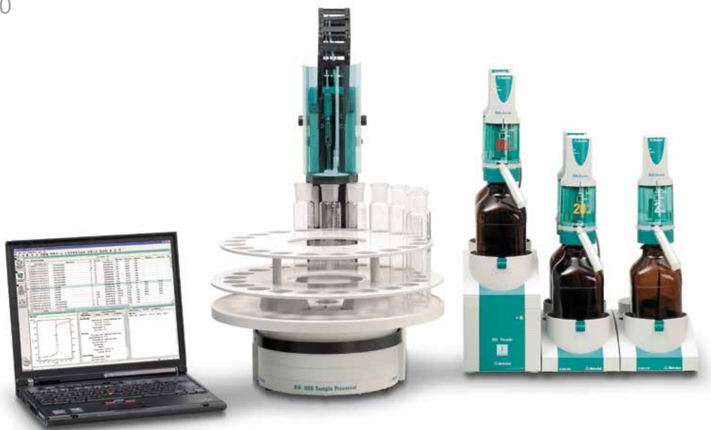
Das MATi 12-System für die vollautomatische CSB-Bestimmung
