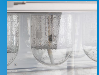
Automatische Reinigung nach jedem Testdurchlauf mit Reinigungsprüfung (SST).
