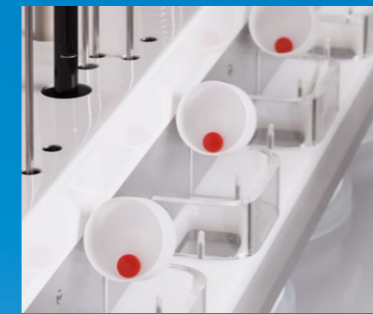
Simultaner Tabletteneinwurf ermöglicht hohe Genauigkeit der Abläufe.
