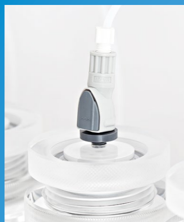
Das neue Quicklock-System am Zellenkopf erlaubt das blitzschnelle Abnehmen der Verschlauchung.
