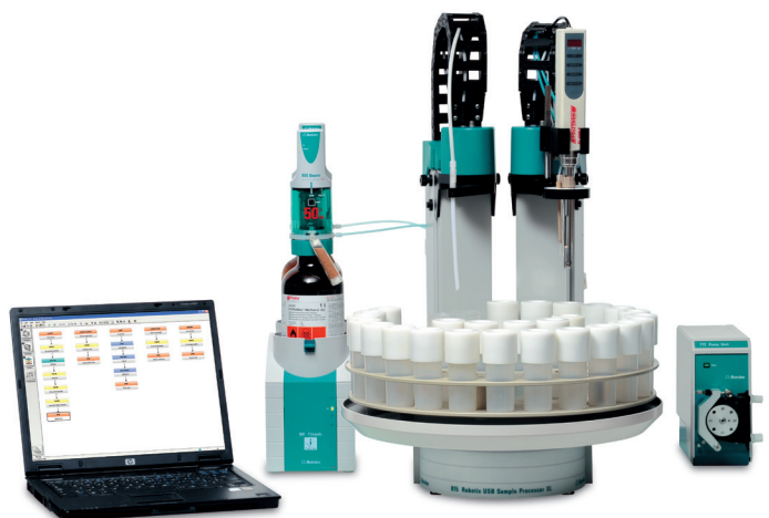
MATI 11 – vollautomatische Karl-Fischer-Titration inklusive Probenvorbereitung
