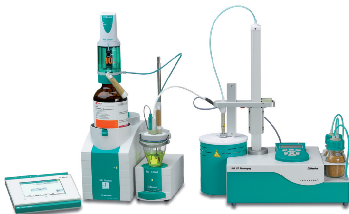
860 KF Thermoprep mit 901 Titrande, 803 Ti Stand und 900 Touch Control
